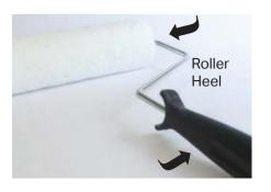
SLIGHTLY ROTATE THE ROLLER HANDLE FROM LEFT TO RIGHT APPLYING A LITTLE MORE PRESSURE TOWARD THE HEEL. THIS WILL ENSURE A NICE EVEN SPREAD OF REMARKABLE<sup>TM</sup> AND ELIMINATE "ROLLER LINES" IN YOUR WALL.
